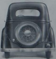
*Vista posterior del Ford Modelo 10. Obsérvese la escasa altura del chasis, la gran amplitud de la ventana posterior y el montaje sencillo y bien acabado de la rueda de repuesto.*
