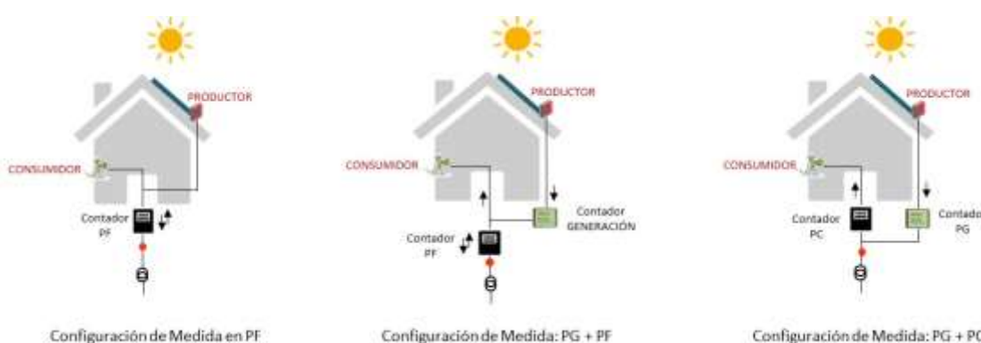
FIGURA 17. Instalaciones INDIVIDUALES con conexión en RED INTERIOR
